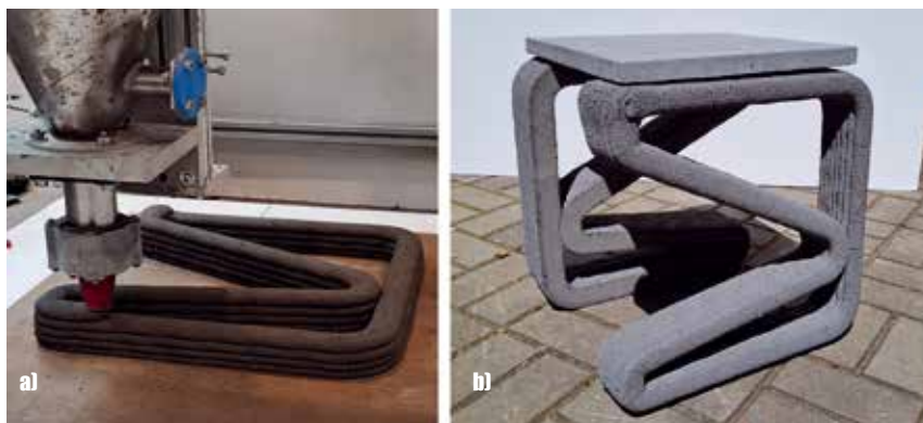
Fot. 1. Siedzisko z nogami wykonanymi w technologii druku 3D kompozytów cementowych: a) noga do siedziska podczas wydruku; b) prezentacja gotowego siedziska
