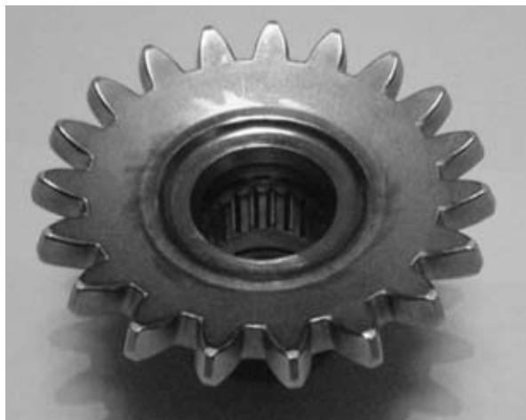
Rys. 1. Zdjęcie koła zębatego przekładni regulatora prędkości obrotowej silnika AI-14RA użytego do badań Fig. 1. The photo of gear wheel of speed governor drive of the AI-14RA engine as a tested object
