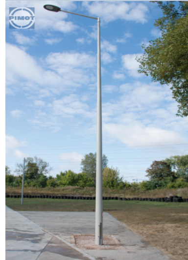
Rys. 2. Słup kompozytowy oświetleniowy o wysokości 9 m przygotowany do testu zderzeniowego na akredytowanym torze badawczym
