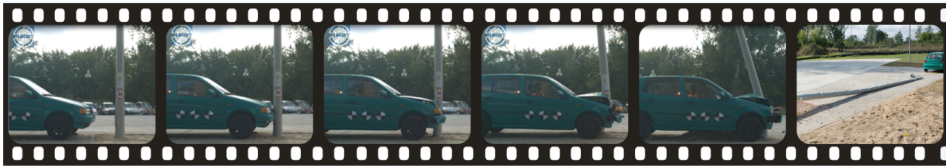
Rys. 5. Kadry z zapisu kamery szybkoeklatkowej poszczególnych faz zderzenia pojazdu ze słupem kompozytowym
