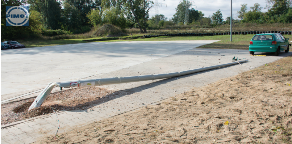
Rys. 4. Słup oświetleniowy kompozytowy wys. 9 m w czasie zderzenia uległ deformacji absorbując energię zderzenia. Pojazd zatrzymał się na odcinku 12 m. Bardzo dobre wyniki dla wskaźników
