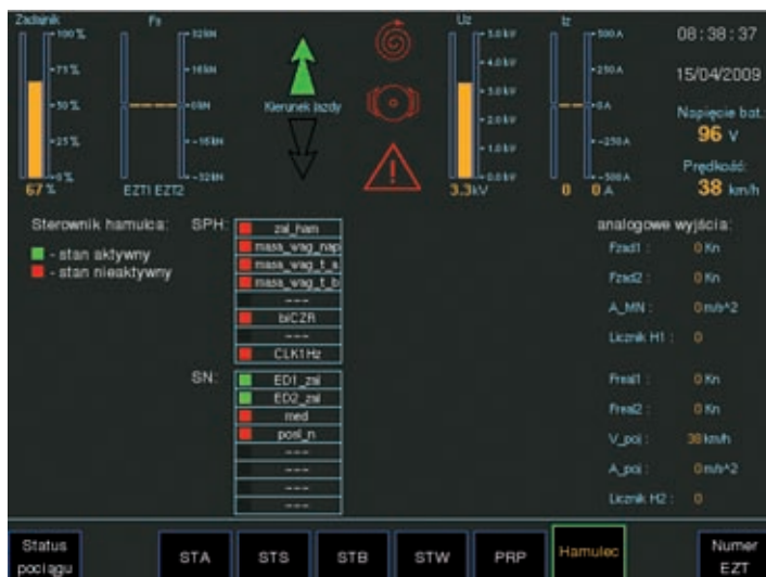
Rys. 8. Ekran diagnostyczny sterownika hamulca na terminalu maszynisty
