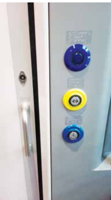
Oznakowanie drzwi do toalety, przycisku informującego o zajętości toalety oraz 2 przycisków otwierających drzwi pojazdu (8 sekund i 16 sekund) w pociągu Łódzkiej Kolei Aglomeracyjnej
