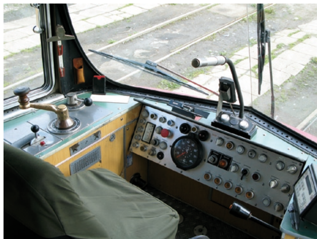
Kabina motorniczego w wagonie GT8; tramwaj przygotowany jest do prowadzenia za pomocą nastawnika – przy włączonym systemie Geomatic rękojeść nastawnika musi być zdjęta, a motorniczy korzysta wtedy z dźwostki (pierwsza dźwignia z lewej)
