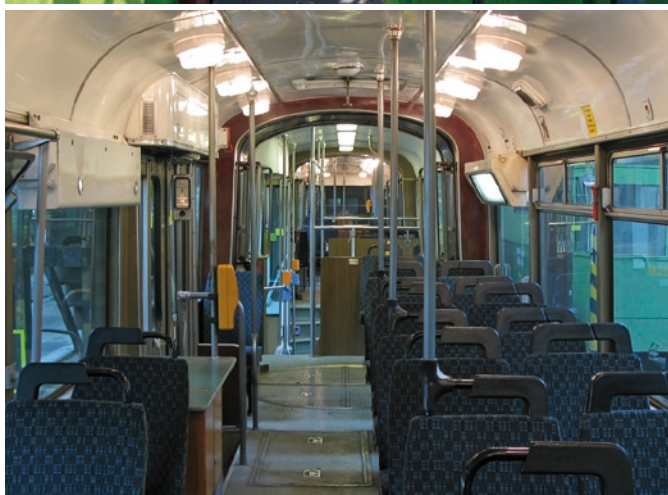
Wnętrze wagonu GT8N 513 w dniu przybycia do Łodzi i po modernizacji polegającej na wymianie oświetlenia i tapicerki siedzeń
