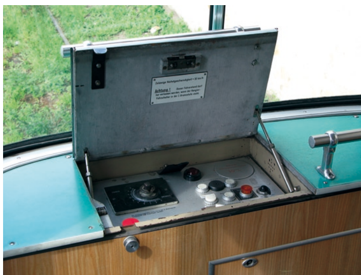
Stanowisko do jazdy manewrowej na tylnym pomoście wagonu fryburskiego
