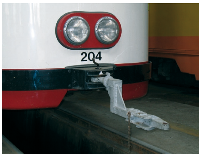
Sprzęgi z głowicą Alberta do tramwajów GT8 i GT8N wykonała MKT według własnego projektu
