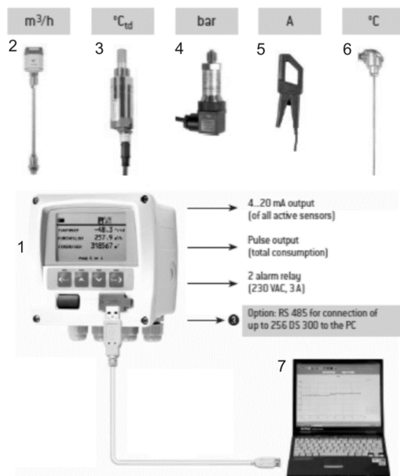
Rys. 6. Zestaw pomiarowy DS300 firmy CS Instruments GmbH: 1 – przyrząd pomiarowy DS300, 2 – przepływomierz, 3 – czujnik temperatury punktu rosy, 4 – przetwornik ciśnienia, 5 – amperomierz cęgowy, 6 – czujnik temperatury, 7 – komputer PC
