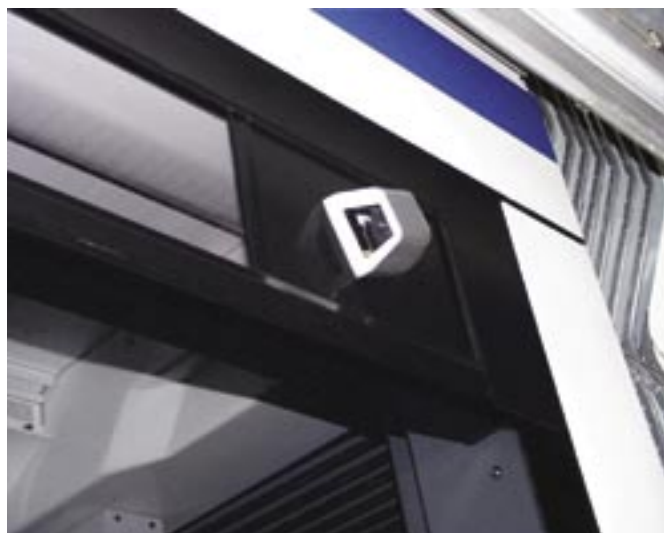
Fot. 4. Kamera do monitorowania drzwi czwartego członu tramwaju
