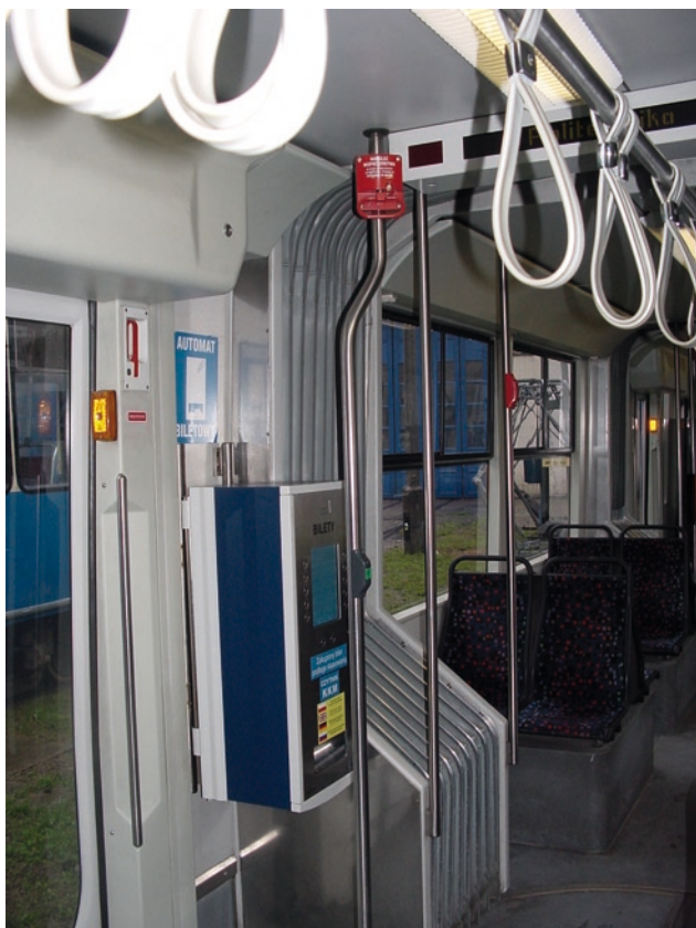
Fot. 4. Przegubowe przejście z automatem biletowym
