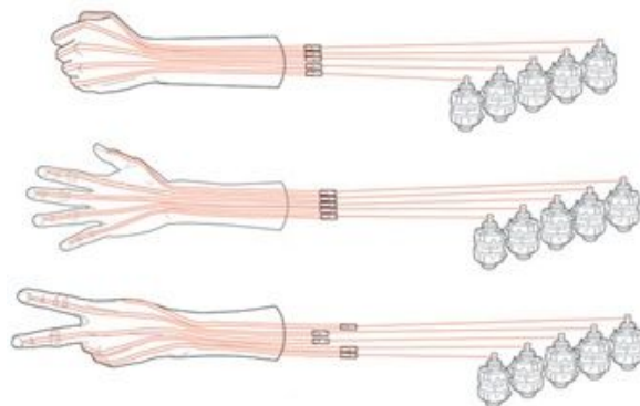
Rys. 2. Idea połączenia napędów do palców
