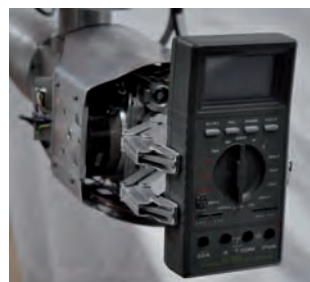
Rys. 5. Chwytnik wielopalcowy trzymający multimetr
