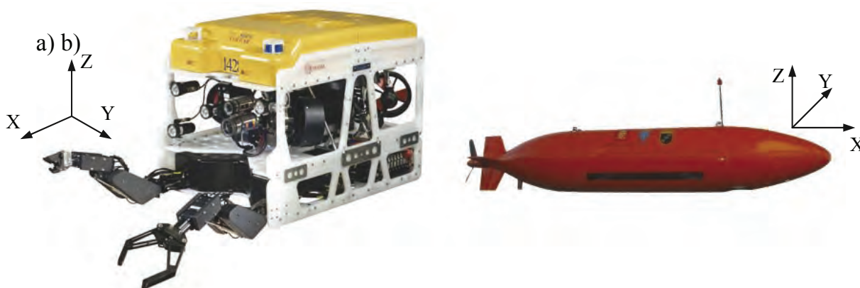
Rys. 1. Podwodne roboty mobilne: a) ROV SEA EYE COUGAR-XT firmy SAAB [10], b) AUV HUGIN 1000 MR firmy Kongsberg Maritime [1]
