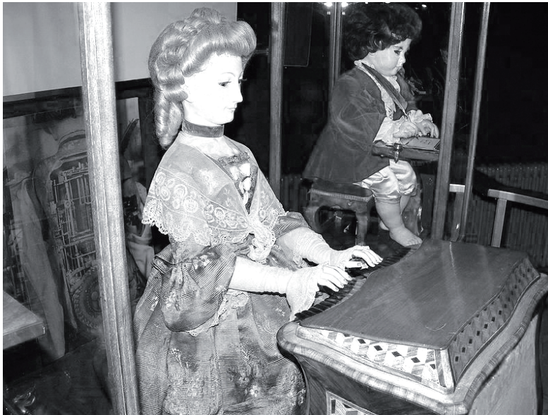
Rys. 3. Androidy napędzane sprężynowo i programowane krzywkowo (XVIII w.) Fig. 3. Cam controlled androids with spring drive
