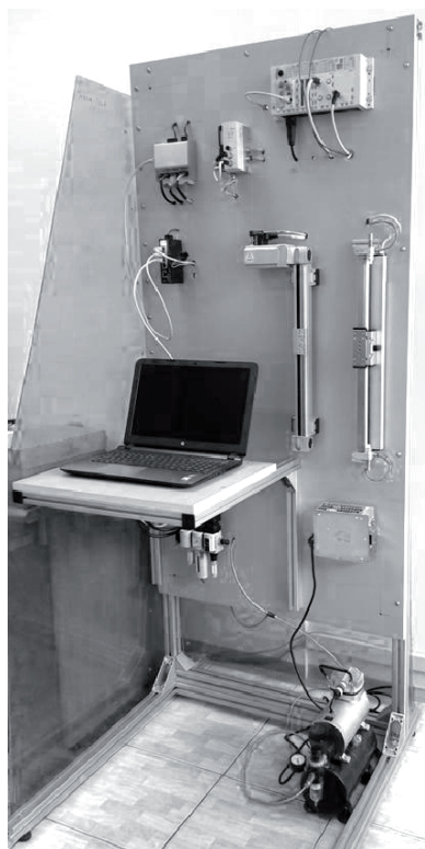
Rys. 19. Stanowisko badawcze zastosowania BCI do sterowania serwo-mechanizmami mechatronicznymi, Instytut Automatyki i Robotyki Politechniki Warszawskiej, Festo (2016) [9, 14] Fig. 19. Research stand of usage of BCI to control the mechatronic servomechanisms
