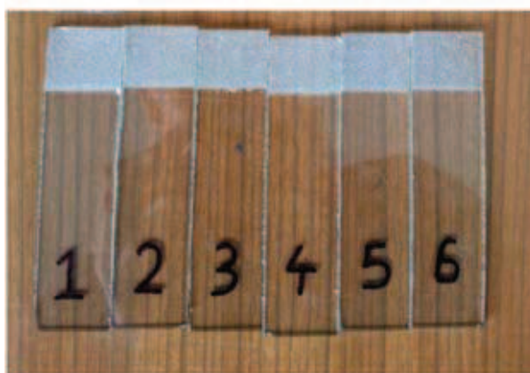
Rys. 4. Wygląd próbek po obróbce piaskowaniem z wysokości 200 mm
