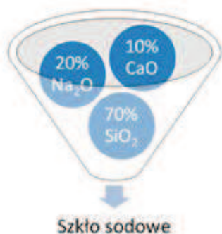
Rys. 1. Skład chemiczny szkła sodowego
