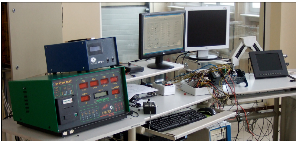
Rysunek 4. Pulpit sterujący z urządzeniem do pomiaru cząstek stałych firmy MAHA-MPM4 Figure 4. A controlling console with a device for measuring solid particles produced by MAHA-MPM4 company
