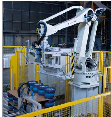
Rys. 15. Stanowisko do paletyzacji wiader z farbą w fabryce Śnieżka SA (Źródło: ASTOR)
