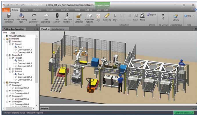
Rys. 1. Stanowisko do sortowania, pakowania i paletyzacji produktów w środowisku RobotStudio firmy ABB
