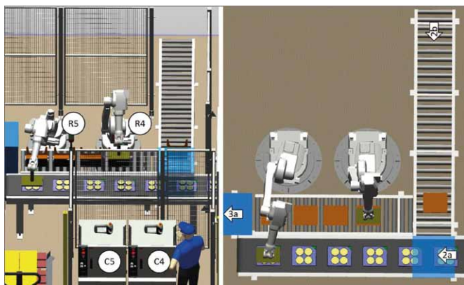
Rys. 5. Stacja pakowania w środowisku RobotStudio firmy ABB: R4, R5 – roboty IRB1600; C4, C5 – kontrolery IRC5 z FlexPendantami; 2a, 2b – transportery dosyłające produkty; 3a – transporter wyjściowy
