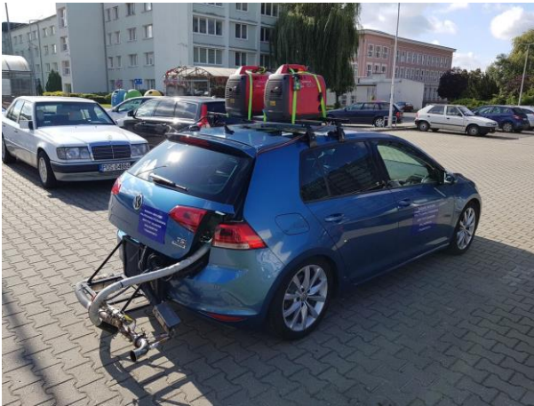
Rys. 2. Badany pojazd z aparaturą badawczą
