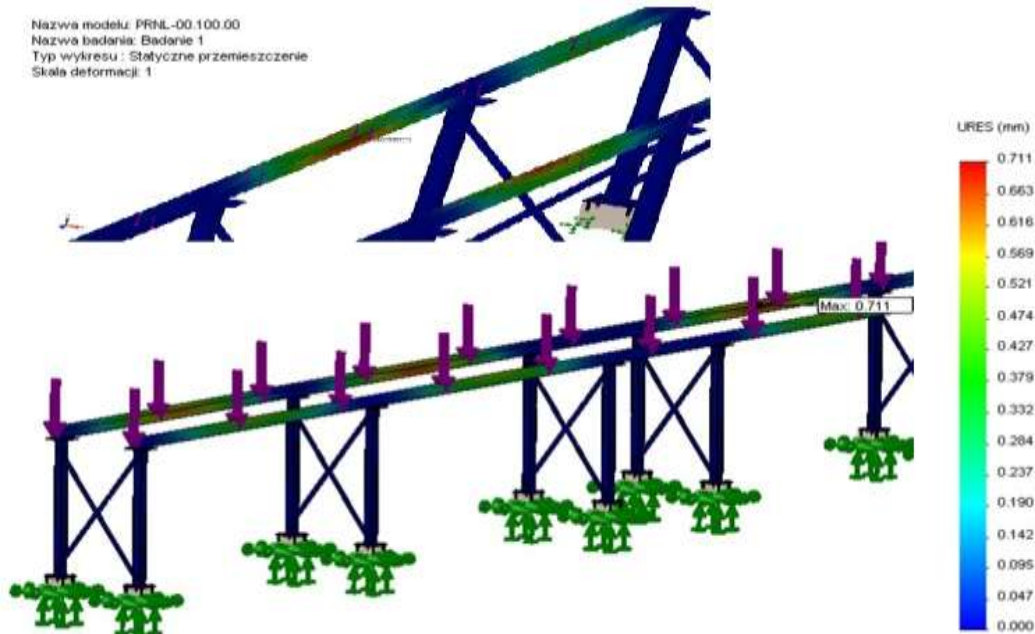
Rys. 7. Rozkład przemieszczeń w ramie podajnika
