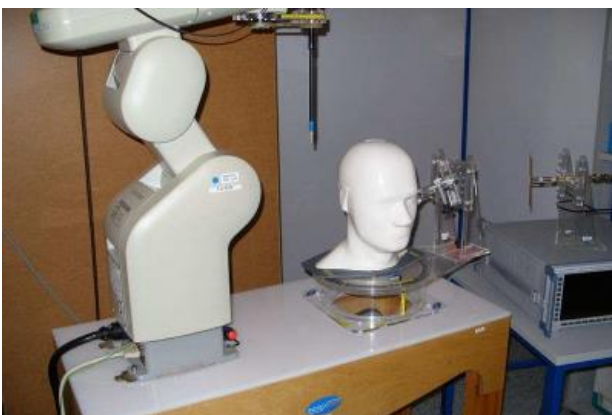
Rys.3. Stanowisko do analizy SAR z wykorzystaniem fantomu (Urząd Komunikacji Elektronicznej w Boruczy)
