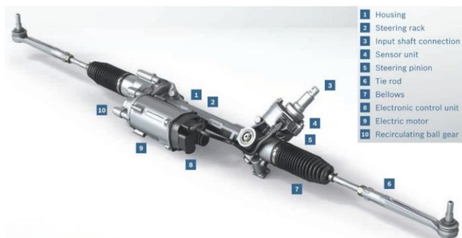
Rys. 3 Przekładnia kierownicza wspomagana silnikiem elektrycznym.
