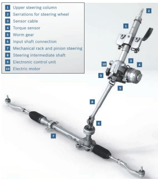
Rys. 2. Kolumna kierownicza wspomagana silnikiem elektrycznym współpracująca z mechaniczną zębatkową przekładnią kierowniczą
