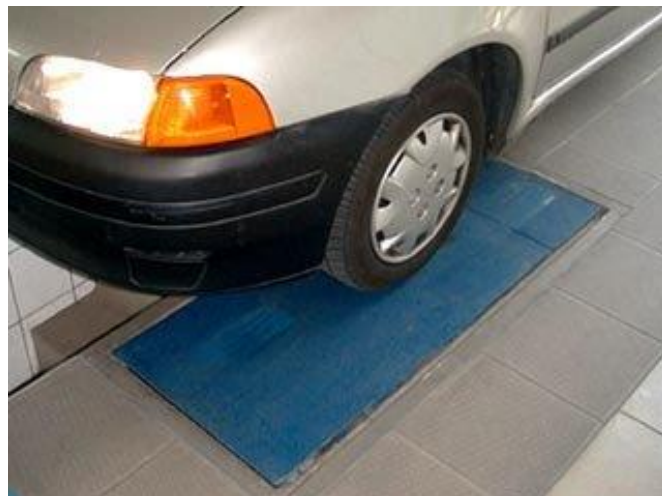
Rys. 6 Badanie zbieżności – najazd na płytę przesuwaną
