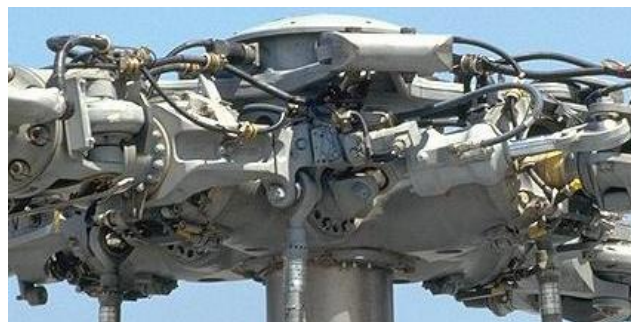
Rys. 11. Kolektor elektryczny śmigłowca BLACK HAWK SH-60B [3]
