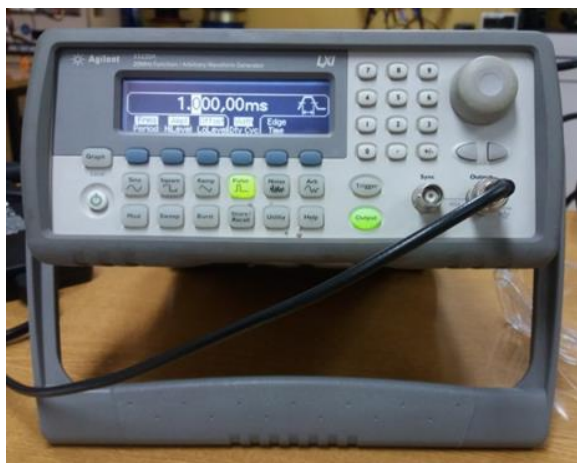
Rys. 9. Generator sygnałów PWM agilent 33220a
