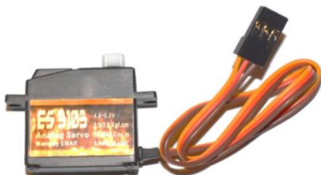
Rys. 5. Serwomechanizm modelarski EMAX ES – 3103
