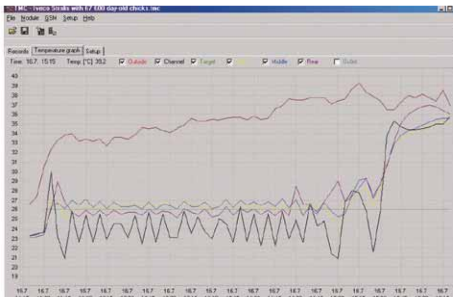
Rys. 4. Diagram dokumentujący warunki klimatyczne panujące w komorze ładunkowej (VEIT Electronics)
