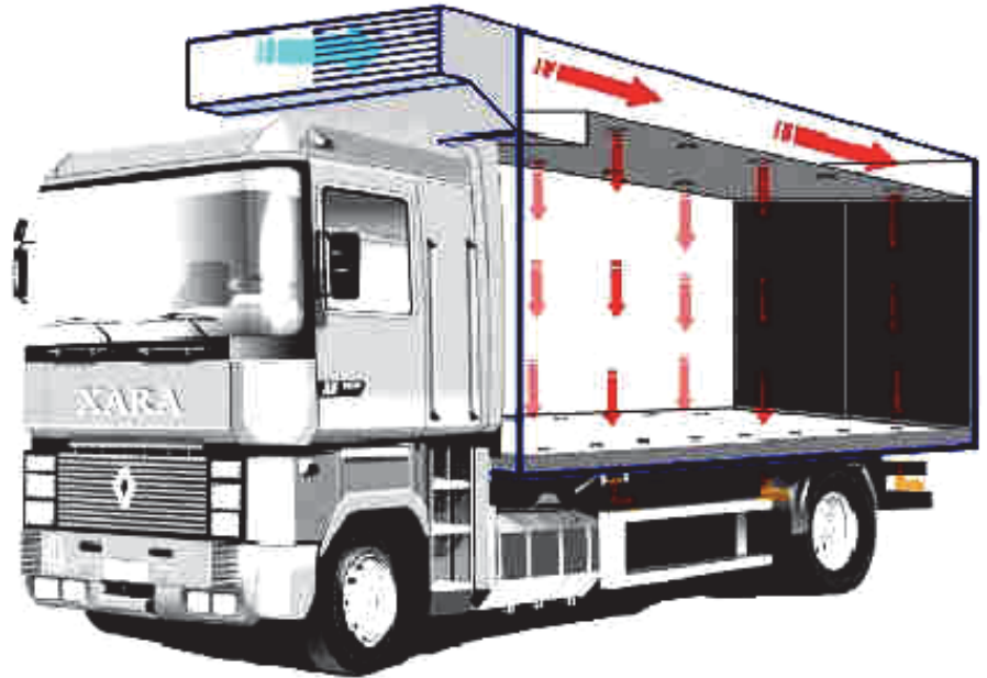
Rys. 2. Przepływ powietrza w klimatyzowanym pojeździe do przewozu piskląt (Acord Bydgoszcz)
