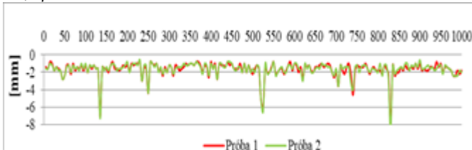
Rys. 6. Profil maksymalnych nierówności z odcinków 5m, planograf 3m, operator I
