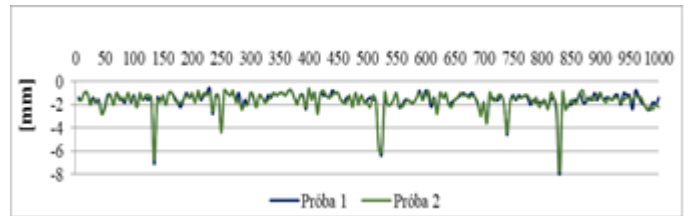
Rys. 7. Profil maksymalnych nierówności z odcinków 5m, planograf 3m, operator II
