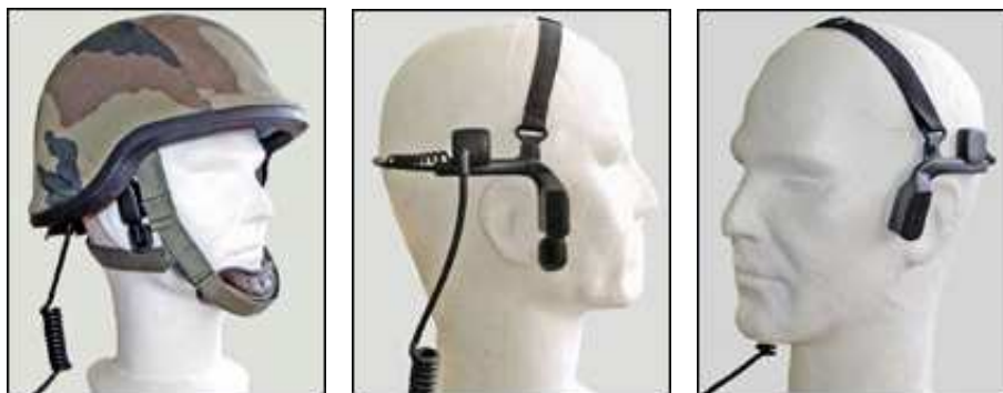
Rys. 4. Osteofon OH-295 nie jest integralną częścią hełmu
