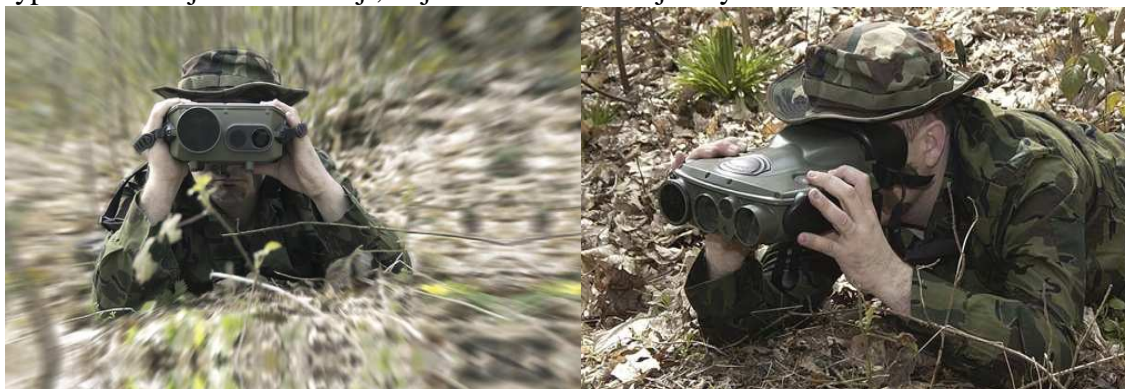
Rys. 7. Wielofunkcyjna lornetka JIM: po lewej MR (średniego zasięgu), po prawej LR (dalekiego zasięgu)
