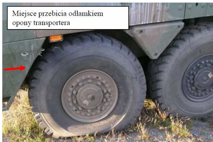
Rys. 1. Widok uszkodzonej opony w wyniku nagłej utraty ciśnienia, związanego z przebiciem odłamkiem
