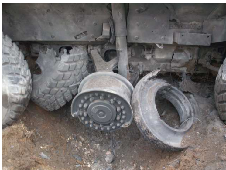
Rys. 2. Widok uszkodzonego KTO w wyniku eksplozji IED pod pojazdem
