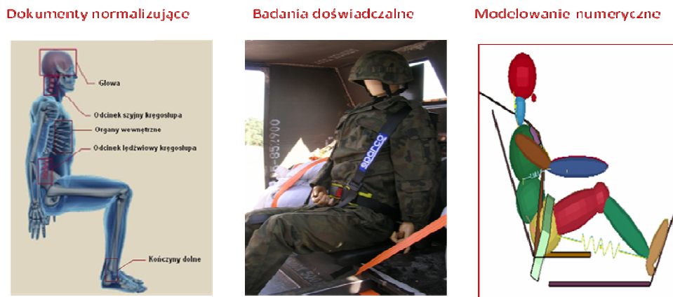
Rys. 5. Etapy identyfikacji oddziaływania fali uderzeniowej wybuchu miny lądowej na załogę pojazdów specjalnych
