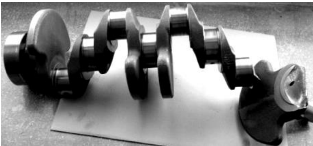
Rys. 5. Widok ogólny uszkodzonego wału korbowego silnika z samochodu Mercedes Sprinter
