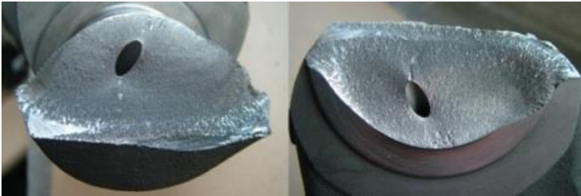
Rys. 6. Przełom zmęczeniowy wału korbowego silnika z samochodu Mercedes Sprinter
