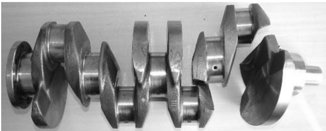
Rys. 9. Przykład uszkodzenia wału korbowego w silniku samochodu Peugeot Boxer
