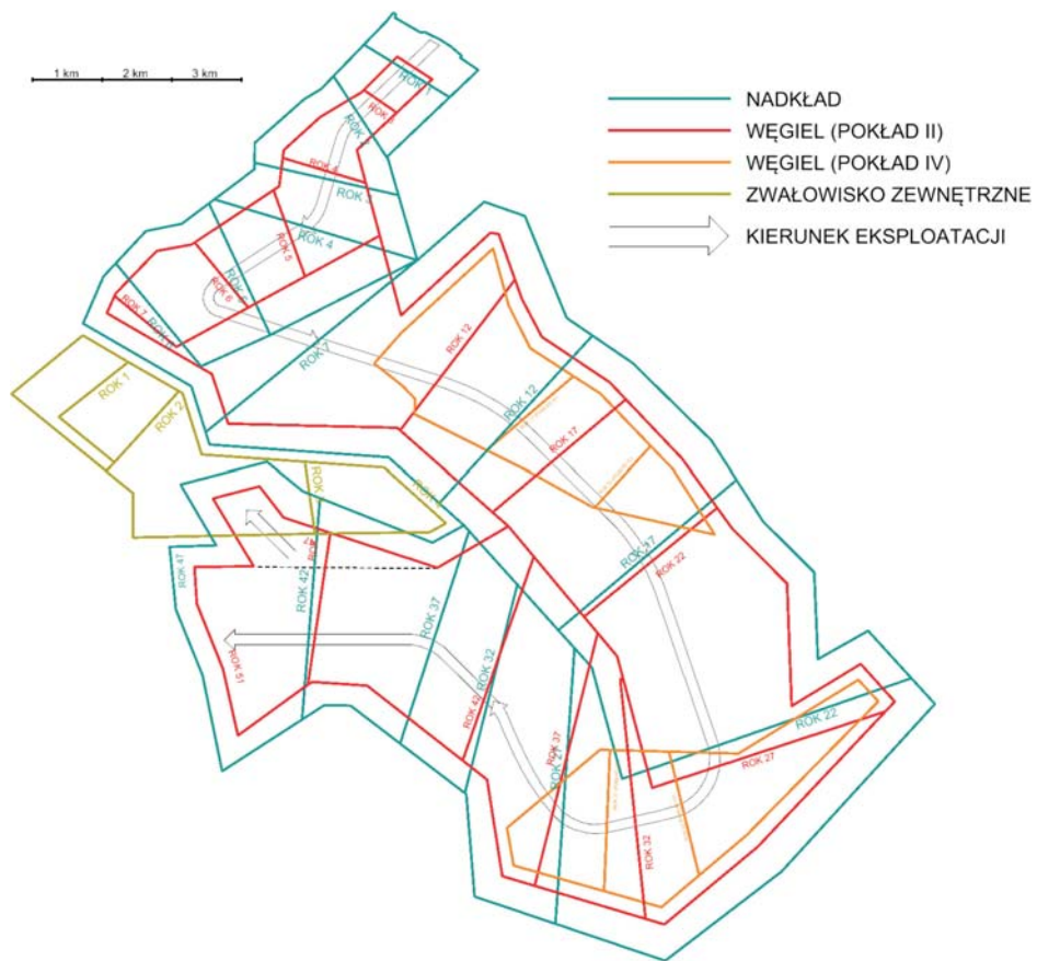
Rys. 4. Postępy frontów roboczych w poszczególnych okresach eksploatacji kopalni (oprac. własne)
