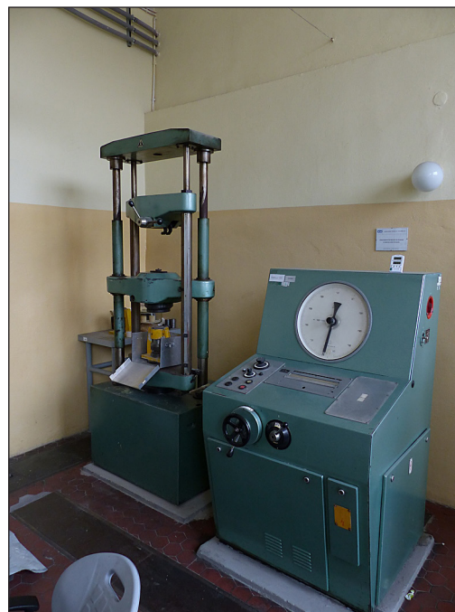
Rys. 6. Prasa hydrauliczna do wyznaczania wytrzymałości brykietów na ściskanie Fig. 6. Hydraulic press for determination of compressive strength of briquettes
