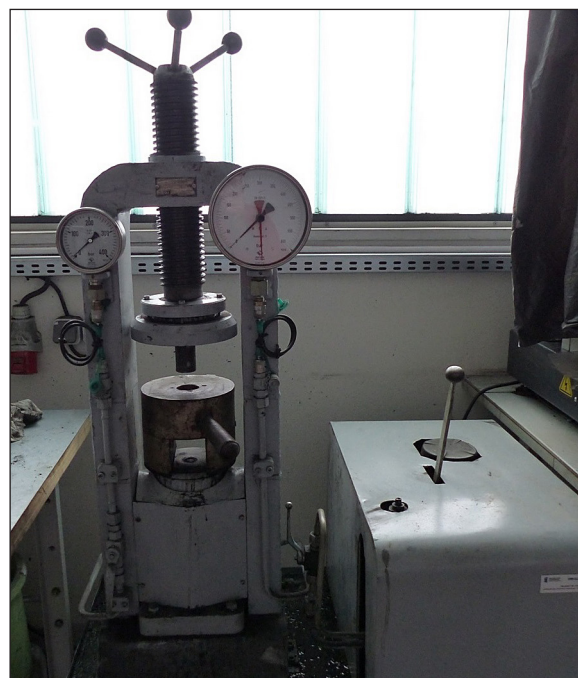
Rys. 4. Prasa hydrauliczna do wytwarzania brykietów Fig. 4. Hydraulic press for briquetting
