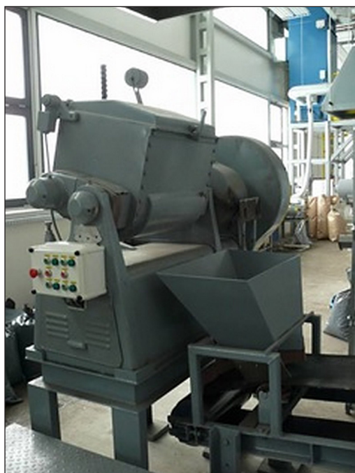
Rys. 3. Mieszalnik dwuwałowy z miesządem typu Z Fig. 3. Twin-shaft mixer with Z-type stirrer
