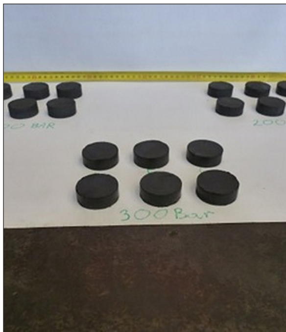
Rys. 5. Brykiety wytworzone na prasie hydraulicznej Fig. 5. Briquettes made on a hydraulic press
