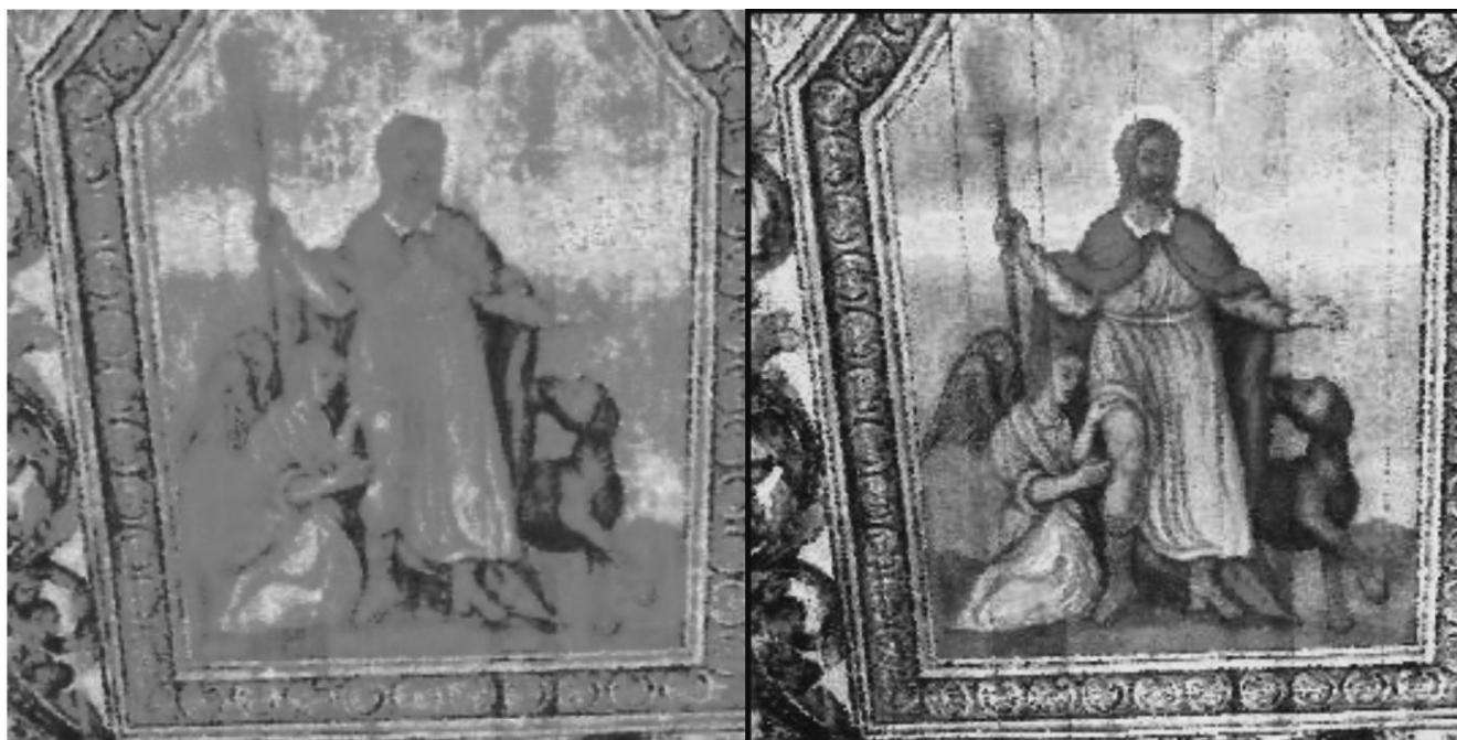
Rys. 1. Mapa intensywności przykładu A (po lewej) oraz chmura punktów z nałożonym na niej zdjęciem rzeczywistym (po prawej)
