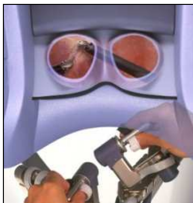
Rys. 2. Wizjer 3D wraz z intuicyjnym manipulatorem robota chirurgicznego da Vinci
