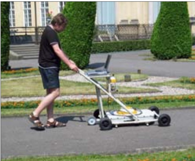
13. Ogród Wilanowski, badania za pomocą georadaru. Fot. A. Gołębniak. 13. Wilanów Gardens, research conducted with the help of a georadar. Photo: A. Gołębniak.
