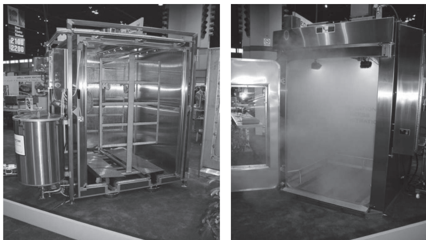
Rys. 6. Instalacje do: A – natryskowego lub zanurzeniowego „wędzenia” ciekłymi preparatami dymu wędzarniczego, B – komora i dysza do aerozolowego rozprzodzenia płynnego dymu i aromatów dymnych
