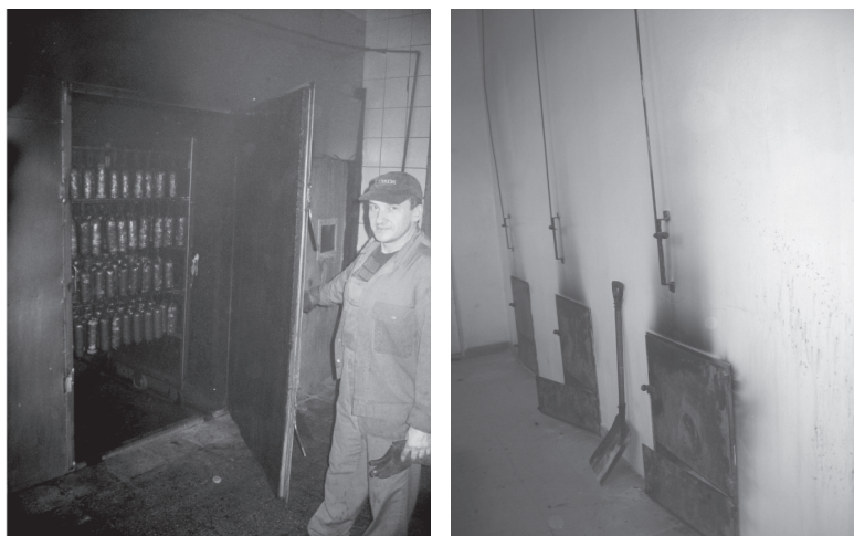
Rys. 3. Tradycyjna komora wędzarnicza bez panelu sterującego w warunkach przemysłowych: A – front komory; B – tył komory-paleniska
