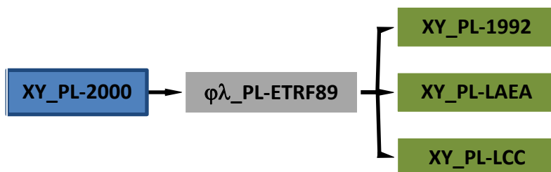
Rysunek 1. Schemat obliczenia współrzędnych punktów siatki
