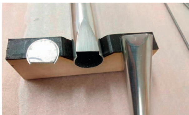
Obr. 9. Příklad řezání nohy píšťaly tenkou pilkou těsně pod úroveň jádra (vlevo) a stav po jejím úplném odřezání (vpravo).
