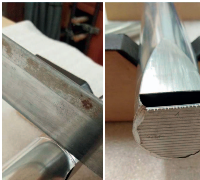
Obr. 9. Příklad řezání nohy píšťaly tenkou pilkou těsně pod úroveň jádra (vlevo) a stav po jejím úplném odřezání (vpravo).
