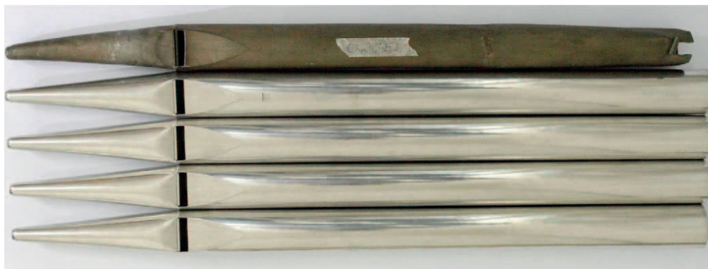
Obr. 1. Vzhled píšťal: vzorová píšťala (zcela nahoře) a výchozí stav jejich kopií (shora dolů) K1, K3, K4 a K5 vyrobených za účelem ověření restaurátorských zásahů akustickým měřením.
