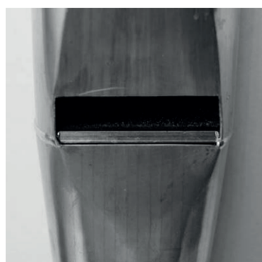
Obr. 10. Příklad stavu píšťaly po vyřezání jejího narušeného jádra (nahore) a stav po naletování nového jádra, sesazení a provedení příčného lotu nad jádrem (dole). Labium po výměně narušeného jádra za nové (vpravo).
