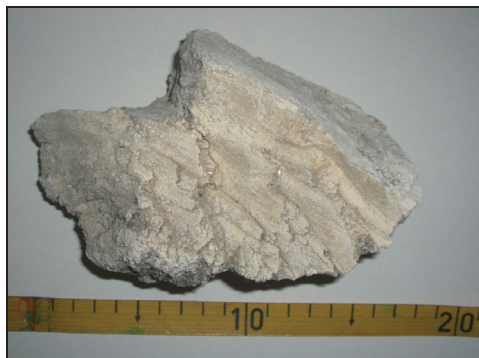
Rysunek 2. Widok z góry na struwitu wykrystalizowany w oczyszczalni ścieków w Łodzi
