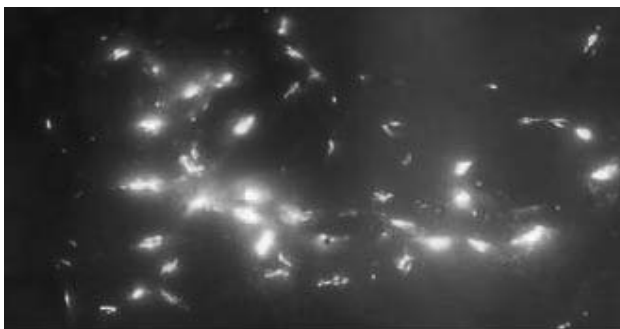
Рис. 1. Утворення плазмових каналів між металевими гранулами
