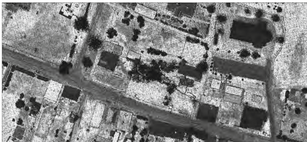
Ryc. 6. Obraz intensywności – wizualizacja chmury punktów z ALS koloryzowanych według wartości współczynnika intensywności odbicia.
