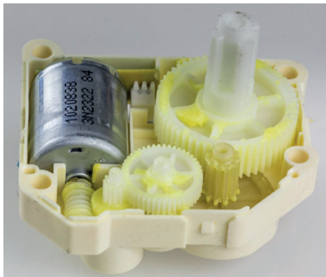
Ilustracja 1. Moduł napędowy koparki Xerox Color Cube 8570 – przykładnia z kołami zębatymi z „plastiku”; super precyzyjne, ekonomiczne, ale czy naprawialne?
