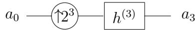
Rysunek 3.8: Układ z jednym ekspanderem i jednym filtrem równoważny kaskadowemu połączeniu trzech układów ekspandera i filtra z rysunku 3.4
