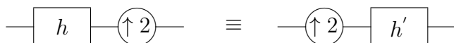
Rysunek 3.5: Dwa układy równoważne: filtr i ekspander oraz ekspander i filtr , gdzie H'(e^{i\omega}) = H(e^{i2\omega})
