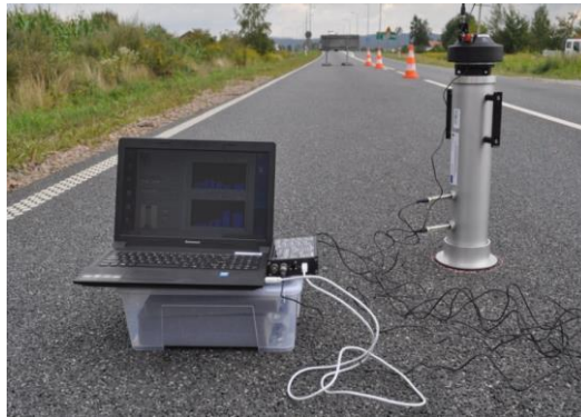
Rys. 5.17. Badanie współczynnika absorpcji na nawierzchni DPAC8+16
