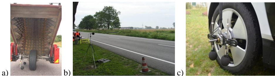
Rys. 3.1. Lokalizacja mikrofonów w metodach pomiaru hałasu: a) CPX, b) SPB/CPB, c) OBSI (zdjęcia ze zbiorów PG, PB i IBDiM)
