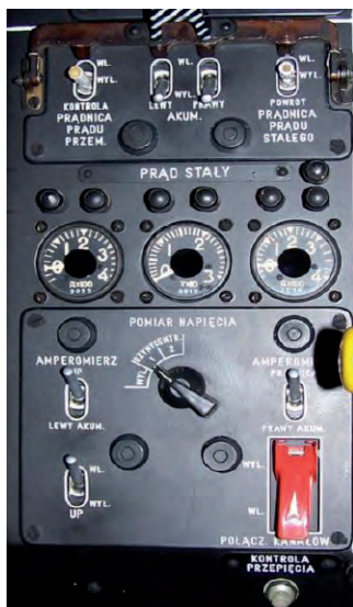
Rys. 3.23. Pulpit górny sterowania pokładowymi źródłami prądu stałego ze śmigłowca Mi-2
