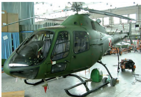
Rys. 5.22. Śmigłowiec SW-4 o niemetalowej (kompozytowej) strukturze poszycia – pod wierzchnią warstwą lakieru jest nałożony (bezpośrednio na warstwę kompozytową) podkład elektroprzewodzący
