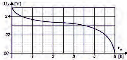
Charakterystyka wyładowania akumulatora ołowianego 12 ogniwowego
