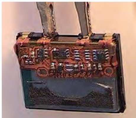
Rys. 4.148. Akumulator Li-Ion firmy Motorola z telefonu komórkowego po zdjęciu obudowy – widoczny układ kontroli i nadzoru ładowania/rozładowania [230]
