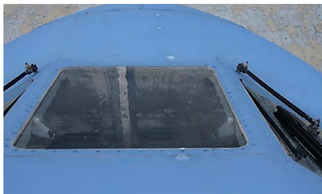
Rys. 5.17. Samolot CASA po uderzeniu pioruna podczas lądowania – ślady wypaleń od uderzenia pioruna w rejonie szyby przedniej kabiny pilotów (jasne koliste przebarwienia)
