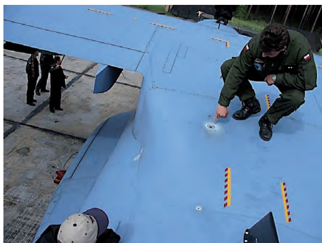
Rys. 5.18. Samolot CASA po uderzeniu pioruna podczas lądowania – ślady wypaleń na kadłubie w rejonie śródpięta
