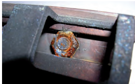
Rys. 4.27. Rdza na nakrętkach śrub mocujących mostki uchwytów szczotkowych do korpusu prądnicy
