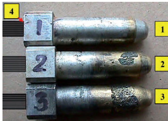
Rys. 4.133. Kołek stykowy złącza wysokoprądowego (przymocowany do konstrukcji płatowca statku powietrznego): 1 – o niskim stopniu zużycia; 2 – o średnim stopniu zużycia; 3 – o wysokim stopniu zużycia; 4 – miejsca połączenia (lutowania) żył przewodzących
