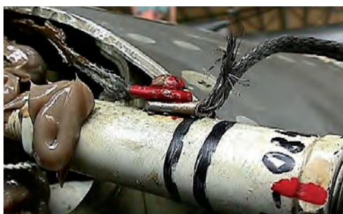
Rys. 5.4. Urwana metalizacja cięga wysuwania slotu samolotu Su-22
