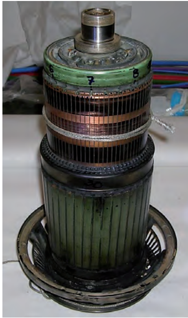
Rys. 4.26. Ślady otarć (zeszlifowań) obwodowych na powierzchniach wirnika prądnicy-rozrusznika
