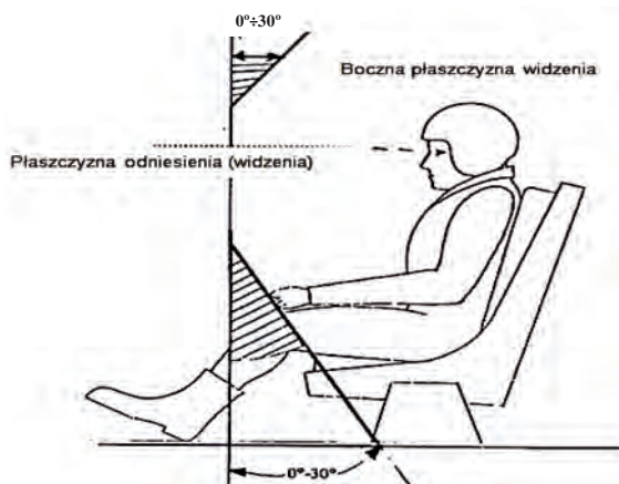
Rys. 3.21. Typowe pochylenia tablic przyrządów – elementy sterujące obwodów elektrycznych – wariant nr 1 – dla elementów sterujących w zakreskowanych obszarach – elementy sterujące „do góry” dla stanu włączenia, „do dołu” do wyłączenia [138]
