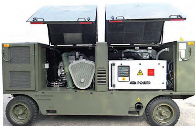
Rys. 4.164. LZE (agregat wielozadaniowy) typ M70D (produkcji włoskiej) etatowo stosowany do naziemnego zasilania samolotu M-346 Bielik – widok ogólny
