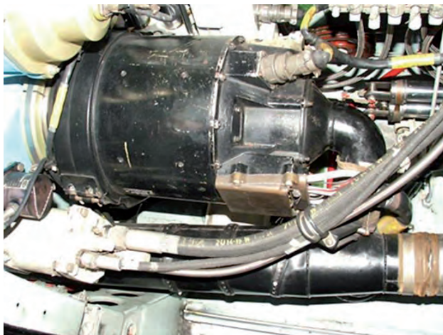
Rys. 4.53. Prądnica trójfazowa bezstykowa prądu przemiennego GT-40PCz8 na śmigłowcu W-3WA Sokół
