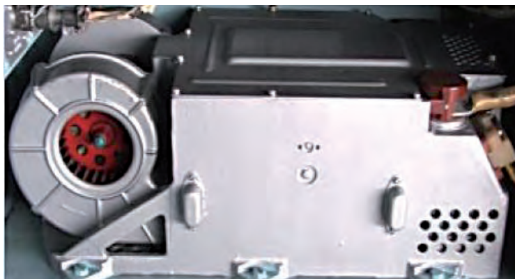
Rys. 4.115. Widok bloku transformatorowo-prostowniczego typu WU-6A
