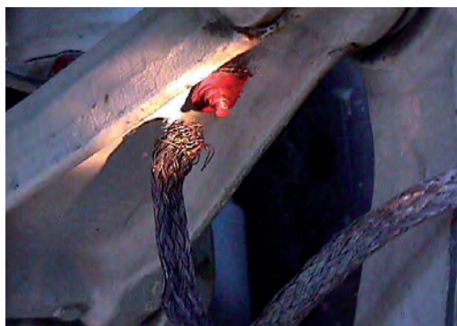
Rys. 5.5. Urwana elastyczna linka metalizacji bocznikująca przegub układu sterowania statecznikiem wysokości samolotu Su-22
