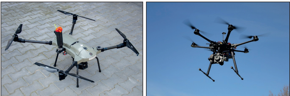
Rys. 1.25. Czterowirnikowy mikrowiropłat Atrax (ITWL) oraz przykład sześciowirnikowego śmigłowca bezzałogowego klasy mikro (Hexa-4) [fot. ITWL; Alexander Glinz, www.wikipedia.org ]
