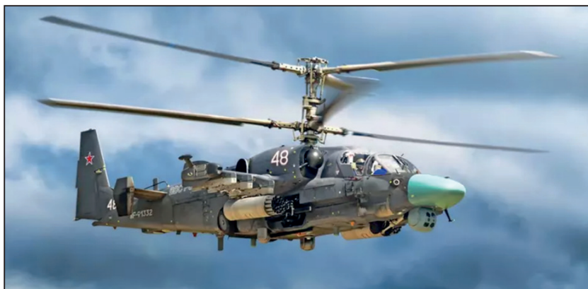
Rys. 1.21. Ka-52 Aligator – śmigłowiec dwuwirnikowy w układzie współosiowym [fot. vala, www.shutterstock.com ]
