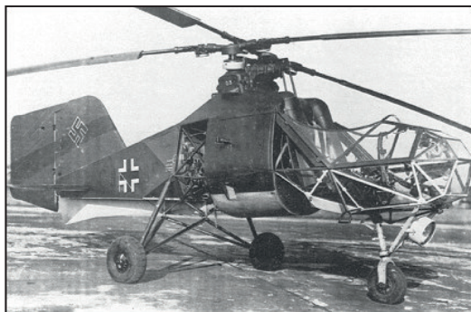
Rys. 1.10. Pierwszy operujący z okrętów uzbrojony śmigłowiec – F1 282 Kolibri [fot. www.aviastar.org ]
