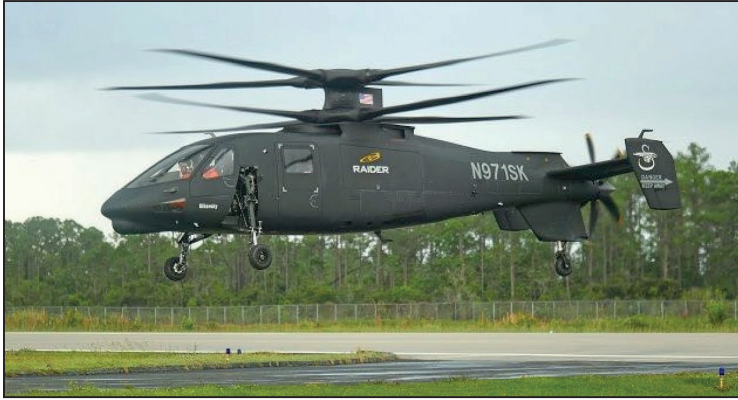
Rys. 1.22. S-96 – współosiowy dwuwirnikowy śmigłowiec z dodatkowym napędem śmigłem pchającym [fot. www.sikorsky.com.au ]
