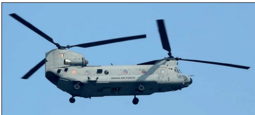
Rys. 1.19. Boeing CH-47 Chinook – amerykański ciężki śmigłowiec transportowy zbudowany w układzie tandem [fot. www.sentinelassam.com ]
