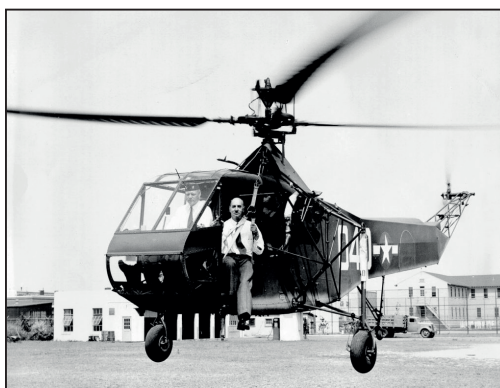
Rys. 1.11. Śmigłowiec R-4 konstrukcji Igora Sikorskiego zbudowany w układzie jednowirnikowym ze śmigłem ogonowym [fot. www.wikipedia.org ]
